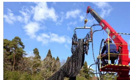
染網（定置網の防汚加工）
